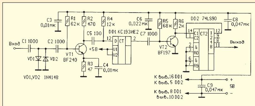
та названной выше микросхемы, осуществляет деление частоты входного сигнала на 100. Принципиальная схема устройства приведена на рисунке. На его входе включен двусторонний диодный ограничитель, защищающий от перегрузки транзистор VT1 при подаче на вход устройства сигналов большого размаха.
