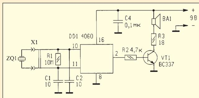
Чтобы генератор возбудился, к нему следует подключить внешний резонатор, резистор (R1) и два конденсатора емкостью по 10 пФ (C1, C2) — генерация возникает на основной частоте резонатора. Затем делитель частоты микро-
