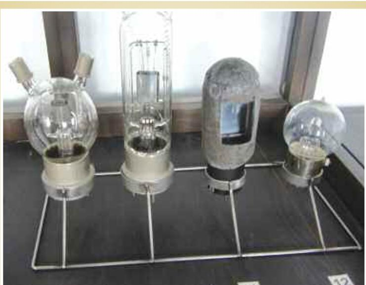
**Опытно-экспериментальные образцы радиоламп (две слева), предположительно, генераторные триоды, предназначенные для передатчиков.**
