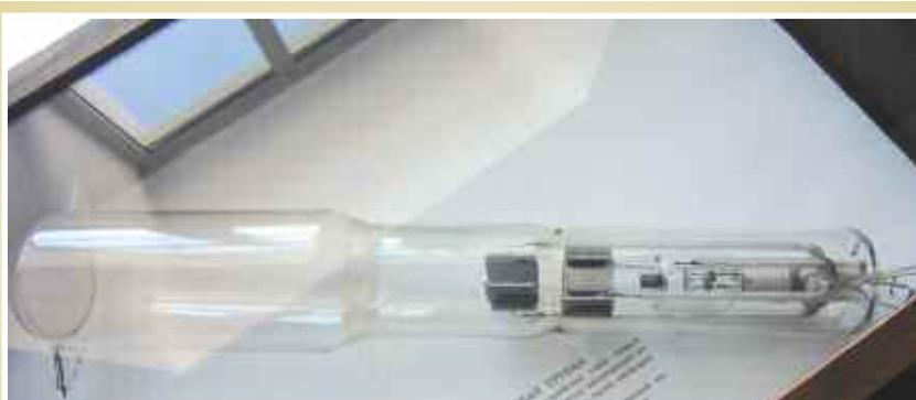
**Осциллографическая электронно-лучевая трубка.**
