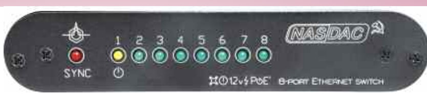
Восьмипортовый сетевой коммутатор.
