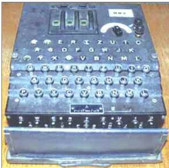
Трёхроторная военная немецкая шифровальная машина "Энигма".
