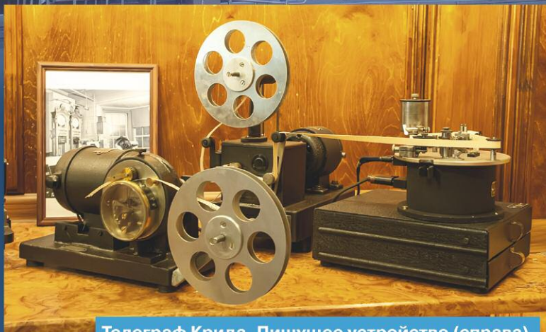
Телеграф Крида. Пишущее устройство (справа). Считывающее устройство (слева).
