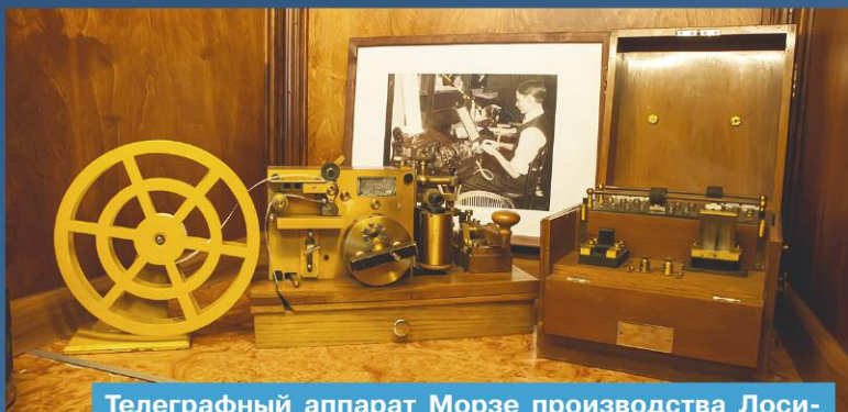
Телеграфный аппарат Морзе производства Лоси- ноостровского завода, 1930г. (слева). Гальваническая батарея для питания телеграф- ного аппарата в "поле".
