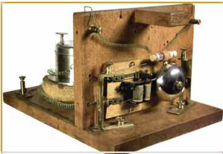
Первый в мире когерентный радиоприёмник А. С. Попова.
