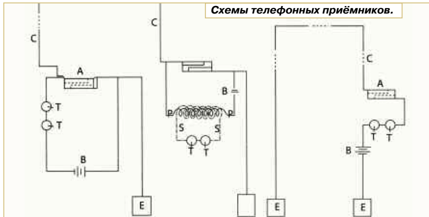
Схемы телефонных приёмников.
