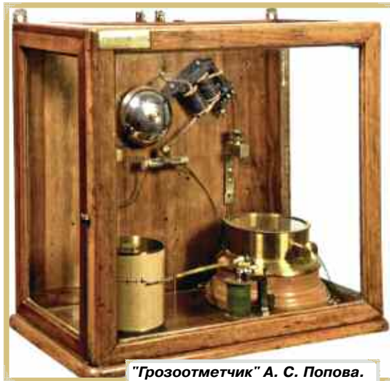
Первый в мире когерентный радиоприёмник А. С. Попова.
