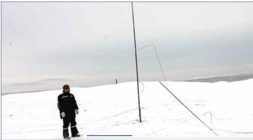
Сломалась антенна GP на диапазон 40 метров.
