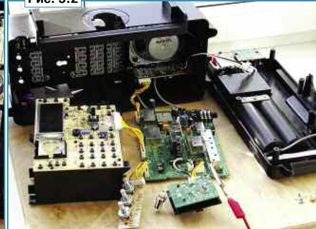
Сначала снимают ручки со всех регуляторов (переменных резисторов) и валкодера. Причём ручка валкодера может быть дополнительно закреплена гайкой. Затем вывинчивают шесть шурупов приёмного блока, здесь выручит длинный пинцет. Все мелкие принадлежности сразу складываем в коробку с надёжной крышкой. Отсоединяют шлейф,
