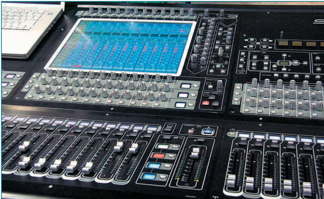
Цифровая концертная консоль DiGiCo SD-10: 96 входных каналов, возможность создания двух радикально отличающихся друг от друга миксов, встроенная обработка и многое другое.
