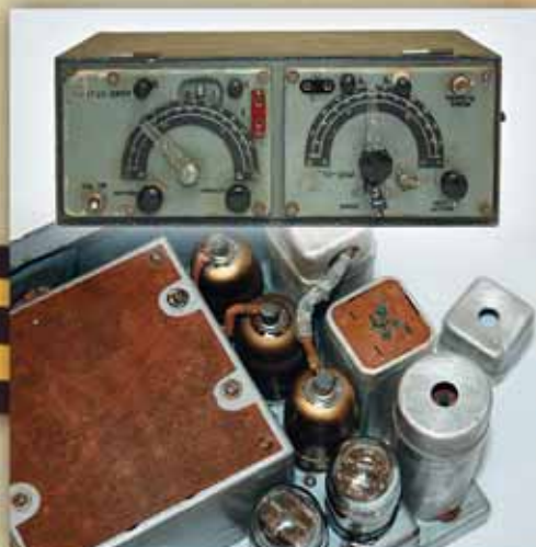
Приемник пехотной радиостанции 12-РП.
