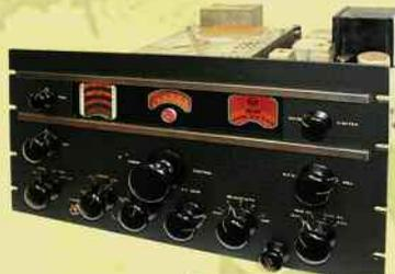
**AR-88-F** — всеволновый приемник AR-88 в стоечном исполнении из комплекта DR-89 для разнесенного приема. Использовались три идентичных приемника, работавших на три разные антенны. Диапазон частот 0,54...32 МГц. Виды работы — ТЛГ и АМ. Питание от сети переменного тока.
