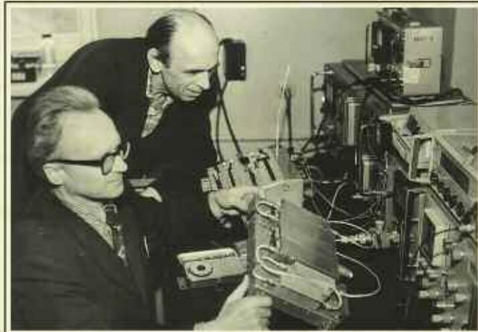
Леонид Лабутин (UA3CR) и Владимир Рыбкин (UA3DV) проводят испытания бортового радиотехнического комплекса радиолюбительского ИСЗ в Общественной лаборатории космической техники.
